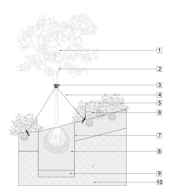
DETALLE 2. PLANTACION DE ÁRBOL EN TALUD <u>ALZADO</u> Esc. 1:25
